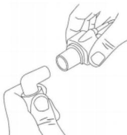
En caso de usarse un sensor de flujo proximal, el capnógrafo o el analizador de gases, se conectará entre el circuito paciente y el sensor de flujo proximal.
