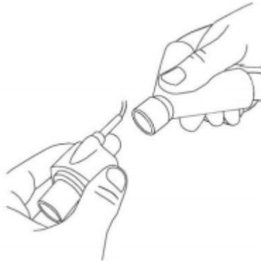
Posteriormente, debe conectar el conector hembra de 15 mm del sensor al accesorio usado como interfaz de paciente.
