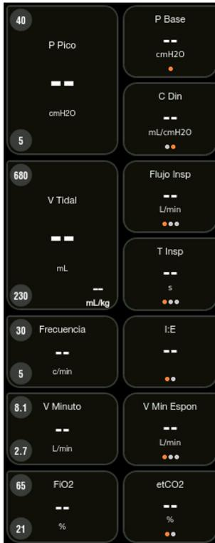
En la parte superior izquierda del recuadro de cada parámetro se indican los valores máximos programados que activan las alarmas, mientras que en la parte inferior izquierda, el mínimo valor. Para ajustar estos valores, se debe presionar sobre el valor de alarma, luego se debe presionar los íconos “-” o “+”, o deslizar lateralmente la barra de ajuste para decrementar o incrementar respectivamente dicho valor. Posteriormente, se debe confirmar o cancelar la selección.
