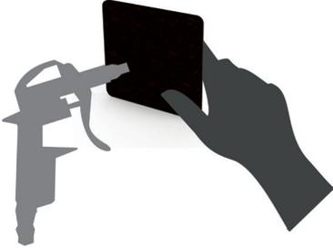
4. Una vez limpio debe colocarse el filtro en la misma posición, ajustando la rejilla y presionando la tapa nuevamente.
