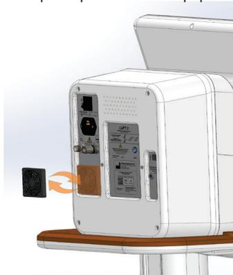
2. Se debe sacar manualmente la tapa negra a presión y luego la rejilla interna que sujeta el filtro.
